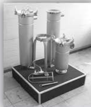
نمونه بگ هوزینگ که بگ فیلترها در درون آنها قرار می گیرند (چپ) و خود بگ فیلترها جهت تصفیه مایعات (راست)
