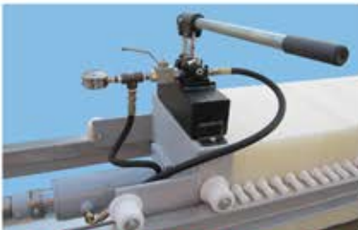
نمونه سیستم پرس جک هیدرولیک با پمپ دستی
